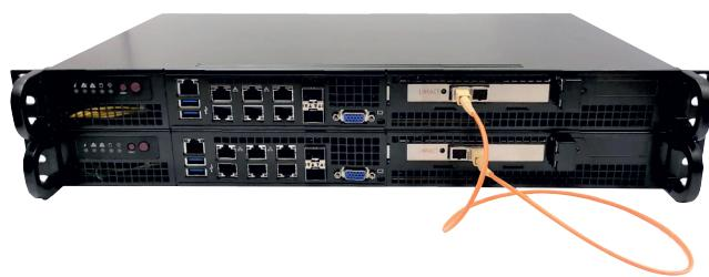
Первое устройство в несекретном сегменте сети забирает файлы с FTP-сервера и передаёт их второму устройству по однонаправленному каналу в секретном сегменте. Второе устройство, после получения файлов, проверяет их целостность и в случае успешной передачи, загружает файлы на FTP-сервер, который расположен в секретном сегменте сети.
